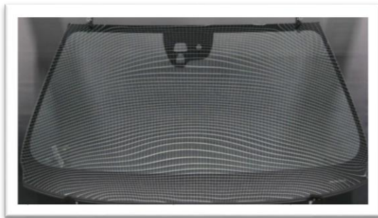
Beispiel einer nicht konformen Nachbauscheibe mit mangelhafter Reflexionsoptik und falscher Krümmung im Kamerabereich und unterem Mittelfeld.
